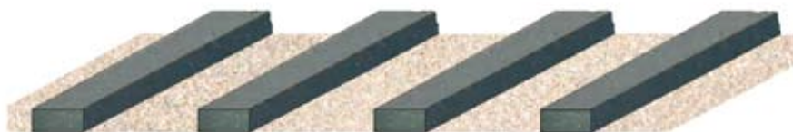
De EKOL-geleidingslatten worden op een effen zandbed geplaatst.
